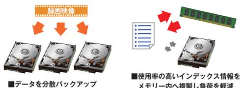
RAID1/RAID5対応ミラーリング機能とデュアルインデックスシステム搭載
