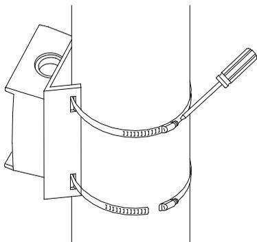
5. ヒンジボルト、カメラ固定用ネジを使ってカメラを固定します。
